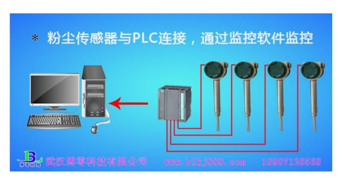
3、粉尘浓度仪与 PLC 连接,主机就地显示,主机输出 4-20mA 信号与上位机连接,通过监控软件在上位机上显示。
